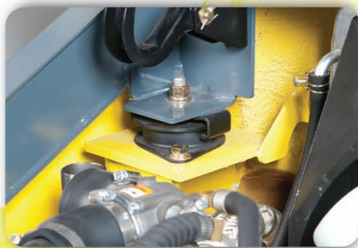
Cabina flotante con amortiguadores que disminuyen la vibración y aumentan el confort
