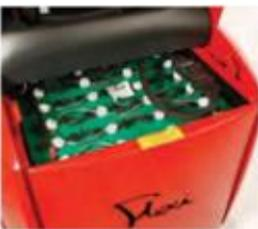
La parte trasera se levanta o desplaza para cambios rápidos. Buen acceso a la cubierta de la batería. Sin motores debajo.
