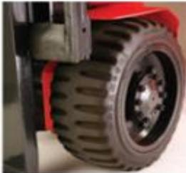
Las ruedas delanteras de Flexi AC 1200 proporcionan excelente agarre y tracción. Llantas rugosas semisólidas Continental MC20 para una vida de servicio prolongada y resistencia al daño.
