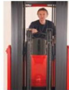
El famoso diseño de mástil triplex de "vista abierta" de Flexi con formato integrado. Horquilla lateral Kaup estándar para una excelente visibilidad de la punta de la horquilla.
