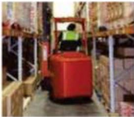
El chasis de 1000 mm de ancho permite la operación de pasillos de 1.80 m sin guía.
