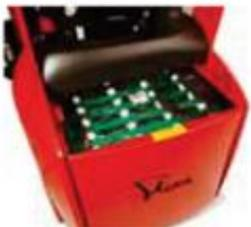
Levante o desplace para cambios rápidos. Acceso libre a la batería sin componentes ni motores debajo.
