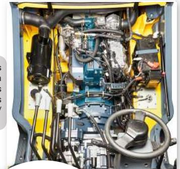
Para proporcionar energía y una mayor eficiencia de combustible tanto en Gasolina, Gas LP o Diesel. La Serie KT viene equipada con un poderoso motor Kubota WG3800 3.8 L para motores de Gas L.P., Gasolina y Duales o un motor Kubota V3800 para los motores Diesel.
