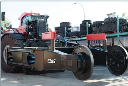
TM20 manipulador telescópico de neumáticos en montacargas
