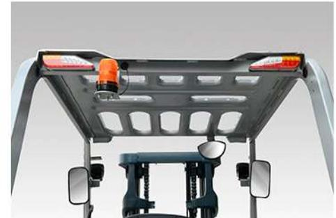
Espejos laterales y retrovisor. Faros delanteros LED, luces traseras LED y luz estroboscópica. Opciones de luz de punto azul u otras alertas visuales para peatones.
