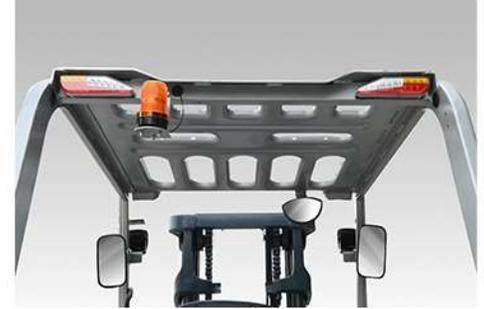
Especiosos espejos laterales y retrovisor. Faros delanteros LED, luces traseras LED y luz estroboscópica. Opciones de luz de punto azul u otras alertas visuales para peatones.
